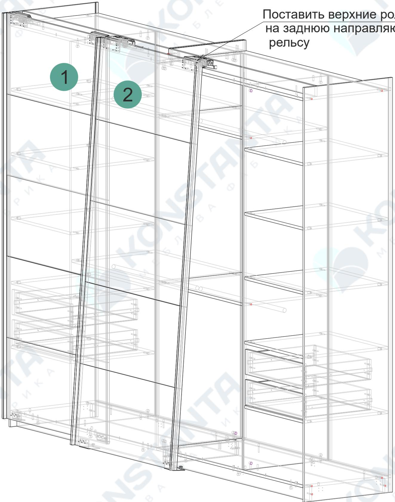
Поставить верхние ролики на заднюю направляющую рельсу
