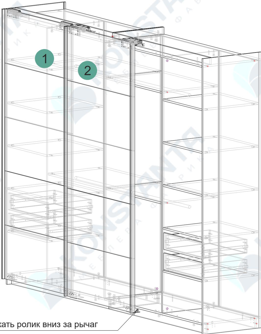
Отжать ролик вниз за рычаг
